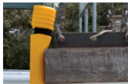
* La protección de columna montada en la estantería supera los requisitos de absorción de impactos estipulados en la norma SS-EN 15512.
