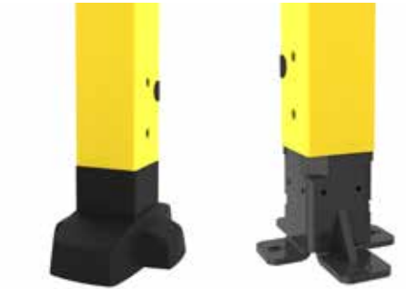
Pie Premium 70x70 mm El poste Premium 70x70 incluye un pie negro con recubrimiento en polvo. Se puede acoplar en cuatro ángulos distintos. Se incluyen tapón superior y perno de expansión para fijación al suelo. Separación del suelo de 100 mm.
