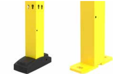
Pie Classic 50x50 mm El poste Classic 50x50 se suministra con una cubierta para ocultar el pie soldado. Se incluyen tapón superior y perno de expansión para fijación al suelo. Separación del suelo de 100 mm.
